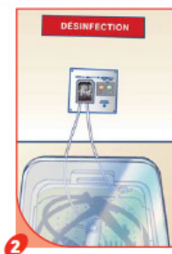
2 Disinfection step : Pour the solution. Cover the tank.
